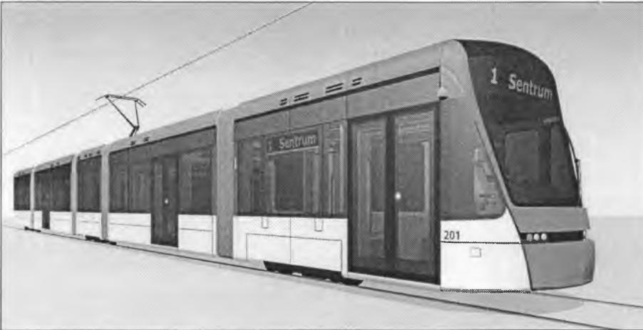
Abb. 4: Designentwurf der Stadler Variotram Bybanen.
