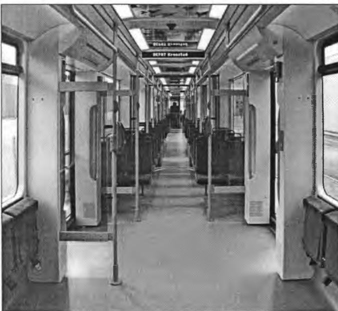
Abb. 7: Innenraum der Variotram Bybanen mit spektakulärer Decke mit hinterleuchteter Dia und aufgehellten Vouten.
